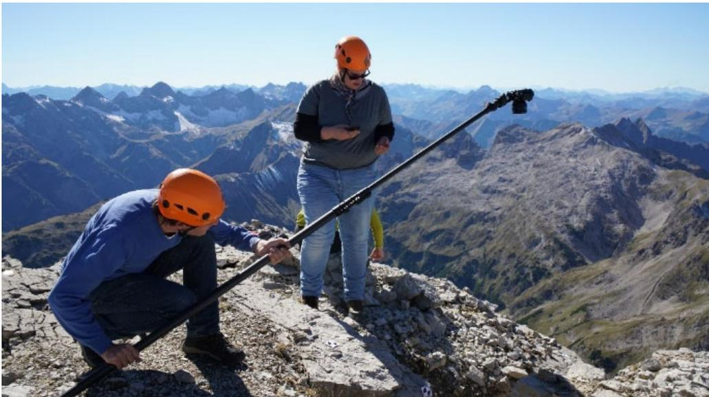
Abb. 2: Photogrammetrische Vermessung der Spalten im Gipfelbereich des Hochvogels mit Stangenstativ, Kamera und WiFi-Steuerung
