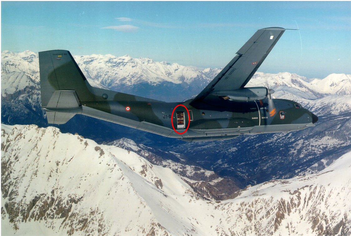
Figure 156 – Capteur RAMSES et son porteur : le Transall
